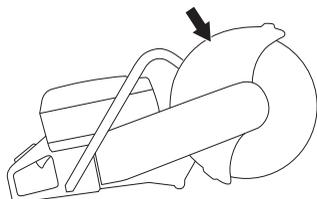
Проверка состояния режущего диска и его шитка.
